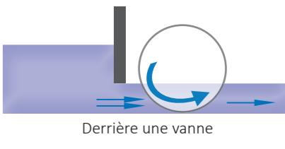
Les hydroliennes ALRELE peuvent être installées au fil de l'eau, flottantes, mais l'installation qui permet de produire le maximum de puissance est derrière une vanne entrouverte.
