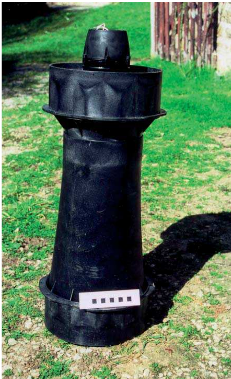
Moulin de la tannerie (Séverac-le-Château) Vue générale de la pico-turbine Pico+@family. L'échelle représente 10 cm (15 mars 2007) - photo JPH Azéma.
